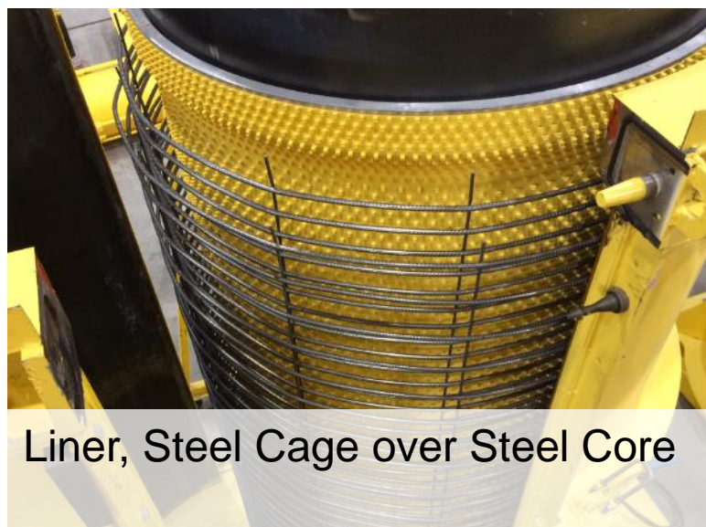
HDPE Liner Roll 1200 anchors per m 2
